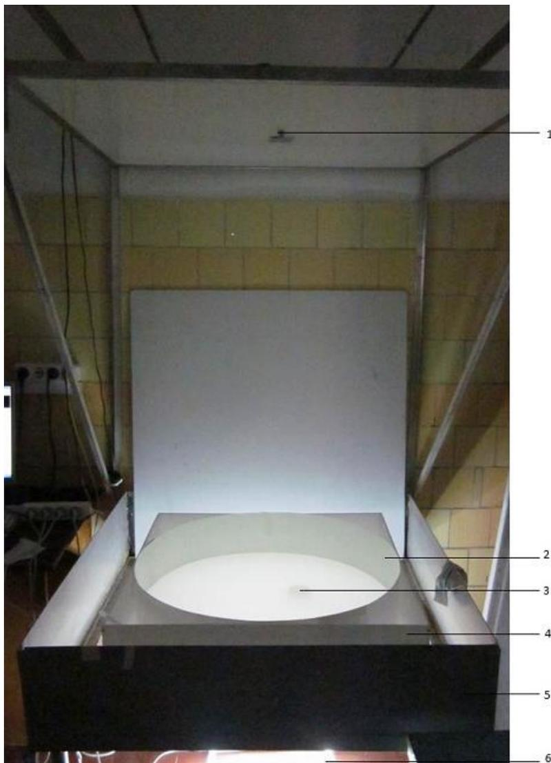
*Рис. 1 Внешний вид установки для проведения теста водного лабиринта Морриса в проходящем освещении. 1- отверстие для объектива камеры 2 - круглый вкладыш для формирования арены 3 - платформа 4 - герметичный, квадратный бассейн 5 - металлические стенки поддона 6 - осветительные лампы*
